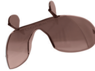
5846 - Nd:YAG and Er:YAG OD 6+ @ 1010-1030 nm, OD 7+ @ 1030-1070 nm, OD 6+ @ 1070-1080 nm, OD 4+ @ 1800-3000 nm
