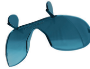
5842 - Multi-Wave OD 8+ @ 180-385nm OD 1+ @ 650 - <730nm OD 2+ @ 730 - <800nm OD 4+ @ 800 - <840nm OD 5+ @ 840 - <960nm OD 7+ @ 960 - 1400nm OD 4+ @ >1400 - <3000nm OD 6+ @ 10600nm
