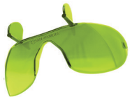
5832 - Universal Soft Tissue OD 4+ @ 800-<900nm OD 6+ @ 900-<980nm OD 7+ @ 980-1064nm OD 6+ @ >1064-1080nm
